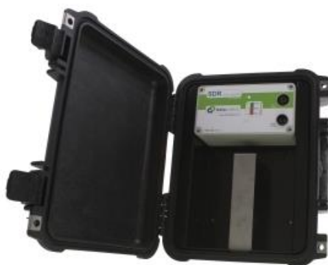
Mynd 3.2 T.v. er ratsjá af gerðinni SDR (DataCollect, 2012). T.h. er ratsjá í notkun í þessu verkefni, fóturinn var smíðaður fyrir verkefnið (ljósm. H.P.).
