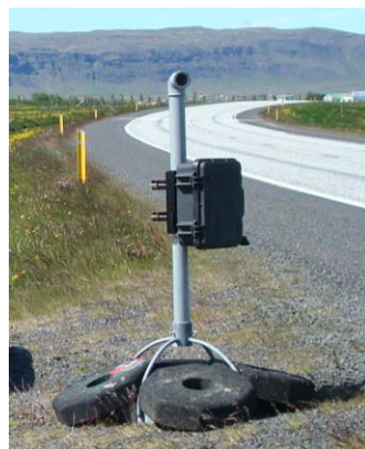
Mynd 3.2 T.v. er ratsjá af gerðinni SDR (DataCollect, 2012). T.h. er ratsjá í notkun í þessu verkefni, fóturinn var smíðaður fyrir verkefnið (ljósm. H.P.).
